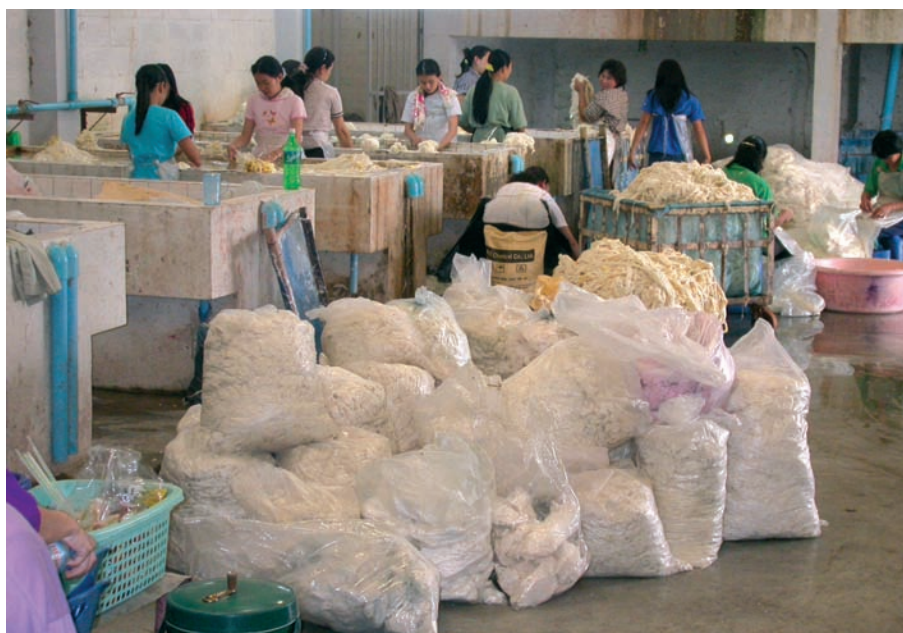
DIE PULPE WIRD NACH FEINHEITSGRAD UND GEBRAUCH SORTIERT.
